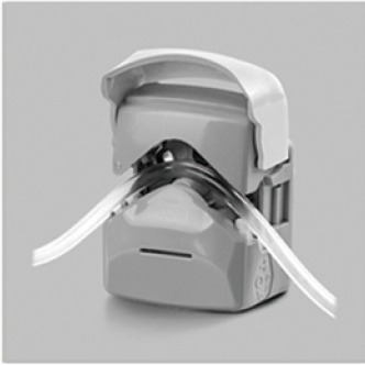
3. 将软管放入泵头。
